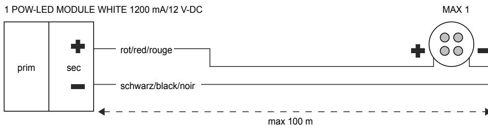
**ACHTUNG:** Anschluss der Netzteile muss stromlos erfolgen, da sonst Entladungen im Netzteil zur Schädigung der LED führen können. Es darf keine Primärspannung anliegen.
